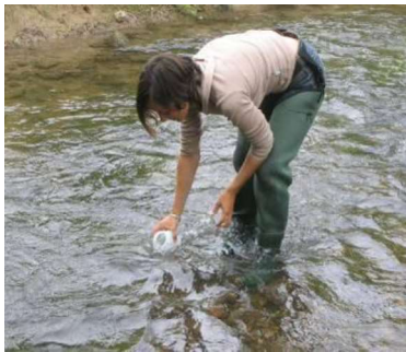
Photo 5 : Prélèvements d'eau et mesures in-situ de O 2 , pH, T°C et conductivité à la sonde multi-paramètres
