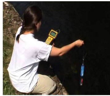
Photo 5 : Prélèvements d'eau et mesures in-situ de O 2 , pH, T°C et conductivité à la sonde multi-paramètres
