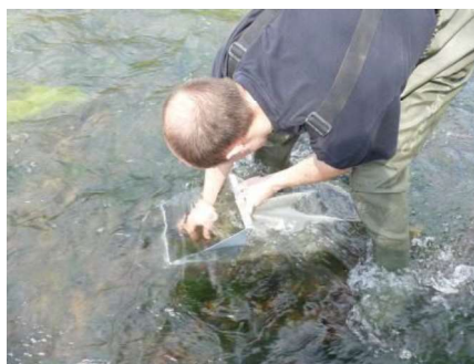
Photo 6: prélèvement d'invertébrés au filet Surber
