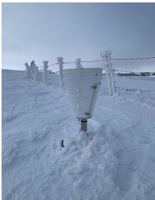
Figure 22: Pluviomètre sur le haut bassin de l'Allier
