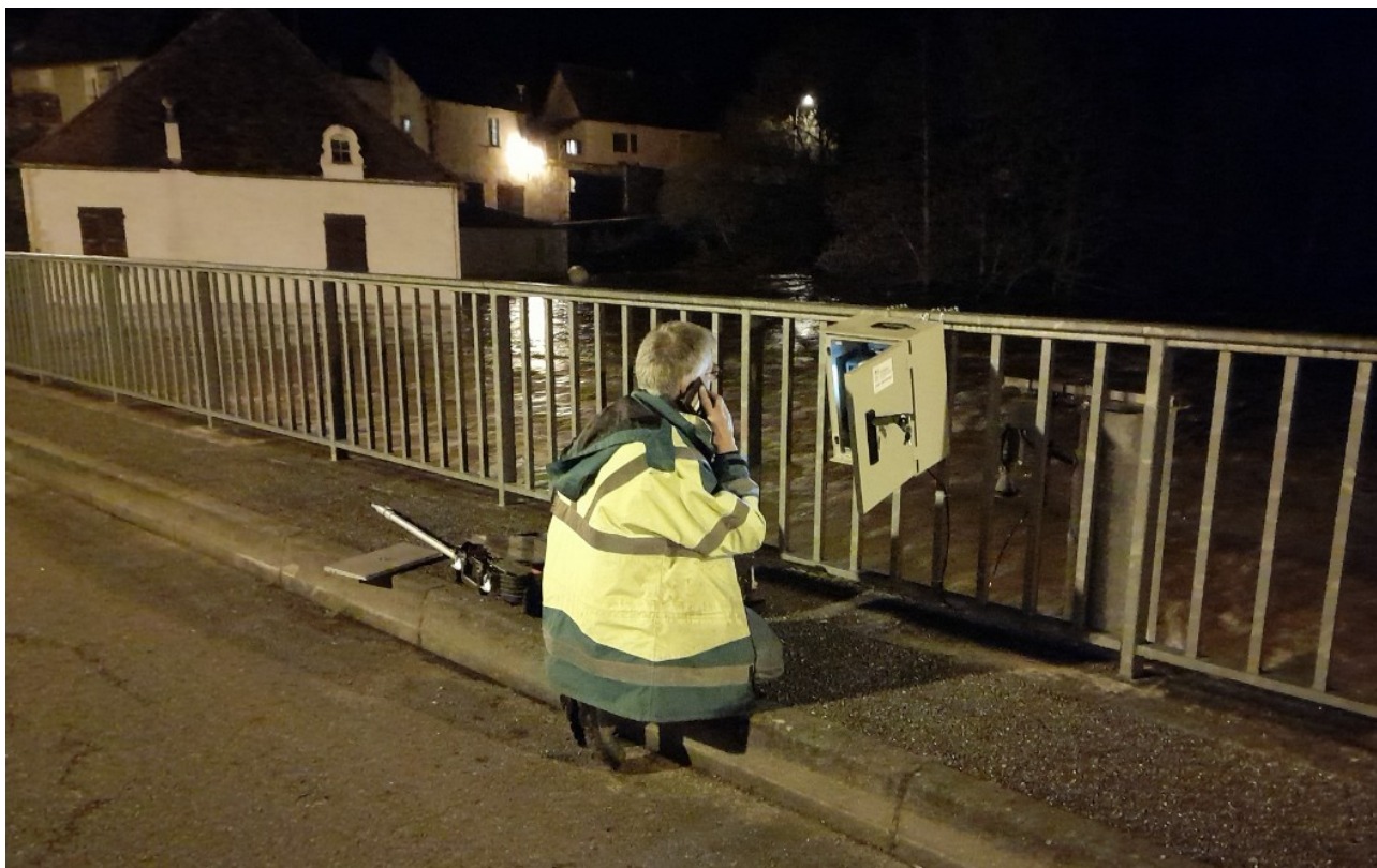
Figure 4: Intervention de nuit d'un agent de maintenance pour rétablir la mesure et sa transmission en temps réel de la station de Mérigny (crue du 30 mars 2024 sur l'Anglin - SPC VCA)
