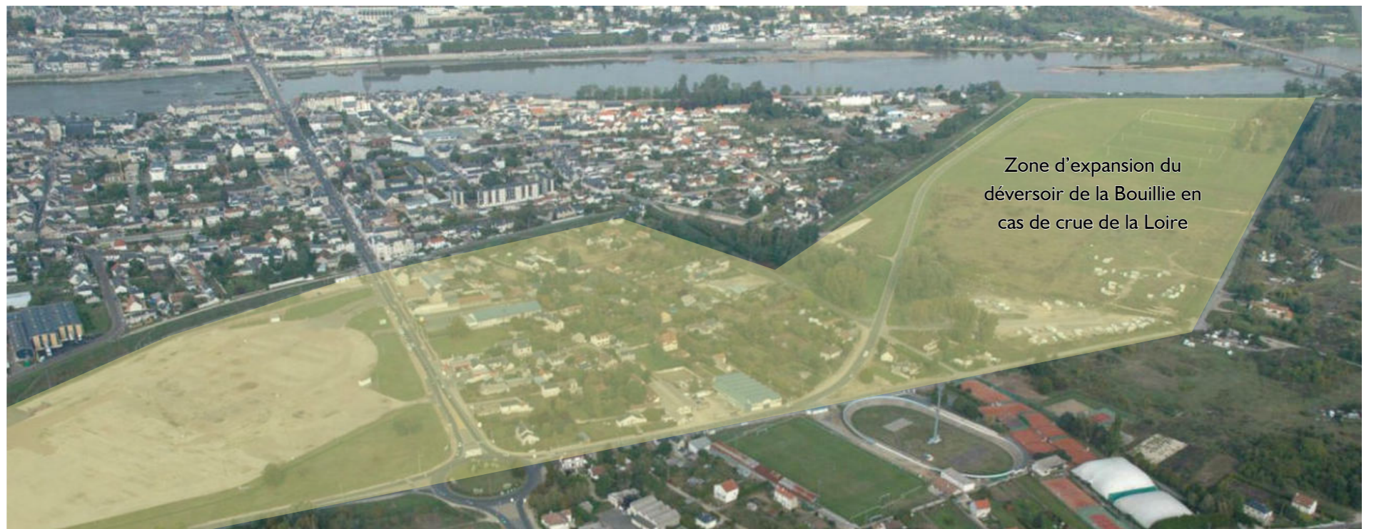
Schéma de l'entrée en fonctionnement du déversoir de la Bouillie - source : Plan de Paysage d'Agglopolys - Agence Folléa-Gautier
