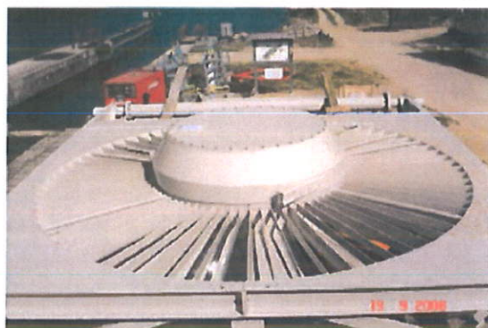
Assemblage de la VLH sur la berge
