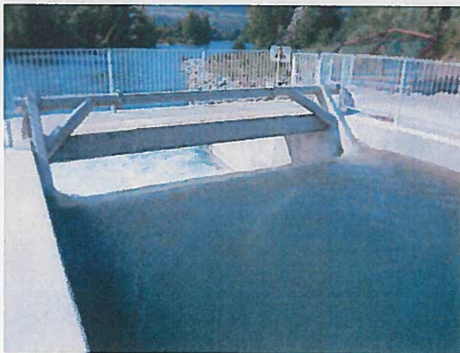
Turbine VLH immergée, en fonctionnement
