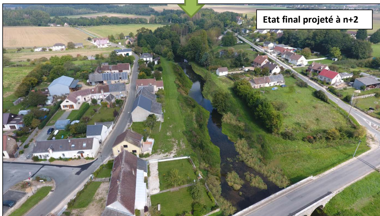
Annexe 5 : Montage photographique de l'état final projeté après rétrécissement de la section et végétalisation des banquettes
