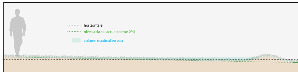
Coupe schématique d'un ouvrage d'infiltration en surface par implantation d'une diguette (échelle 1 : 100)
