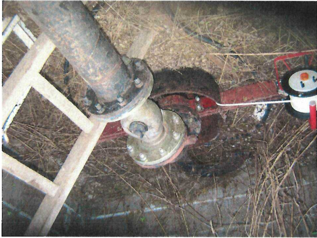
Forage tube en acier 457mm. Tête de forage = repère des mesures vidéo.
