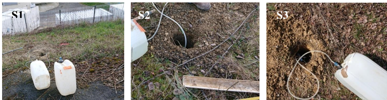
Figure 5 : Photographies des essais de perméabilité
