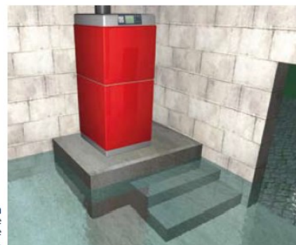
Protection d'un équipement de chauffage par surélévation.
