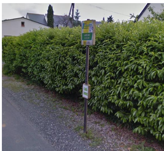
Arrêt Le Carroi : accessibilité piétonne peu qualitative, pas d'abris bus ni information voyageurs, absence de zébras
