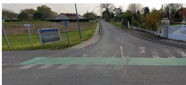
Traversée piétonne vieillissante non réglementaire avec signalisation au sol effacée, à l'entrée de la rue du Val Joli
