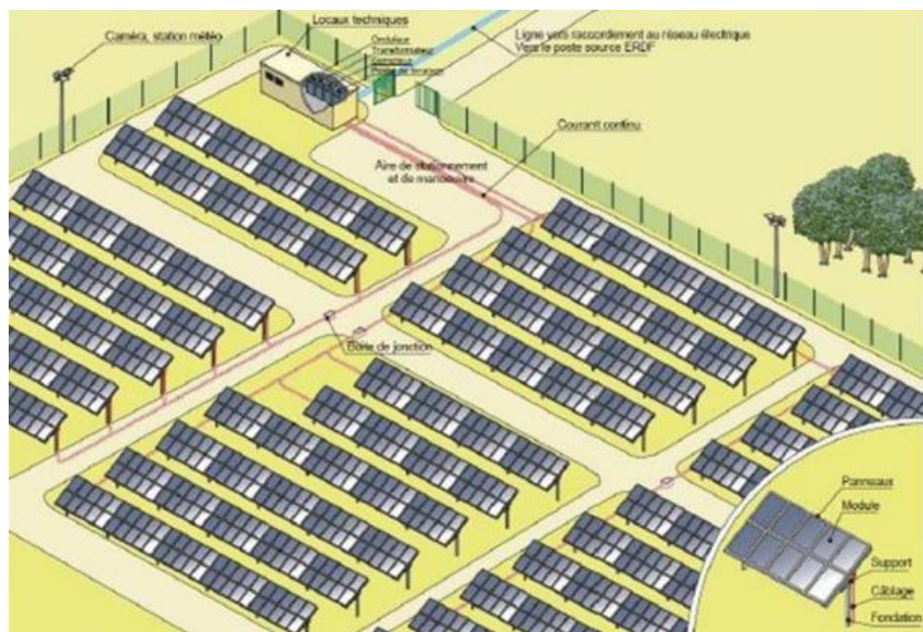
Schéma de principe d'un parc solaire PV
