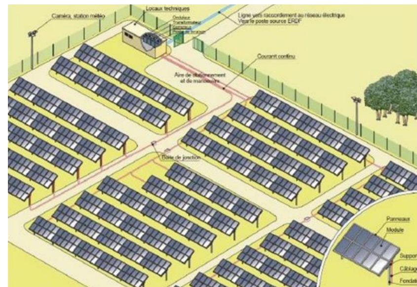
Figure 7 : Schéma de principe d'un parc solaire PV
