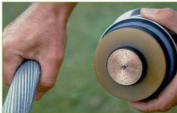
Figure 17. Présentation à gauche d'un câble nu aérien et à droite un câble souterrain isolé
