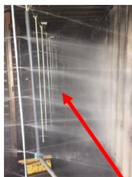
Figure 27 : Illustration du branchement permettant l'inondation du container ainsi que la pulvérisation d'eau
