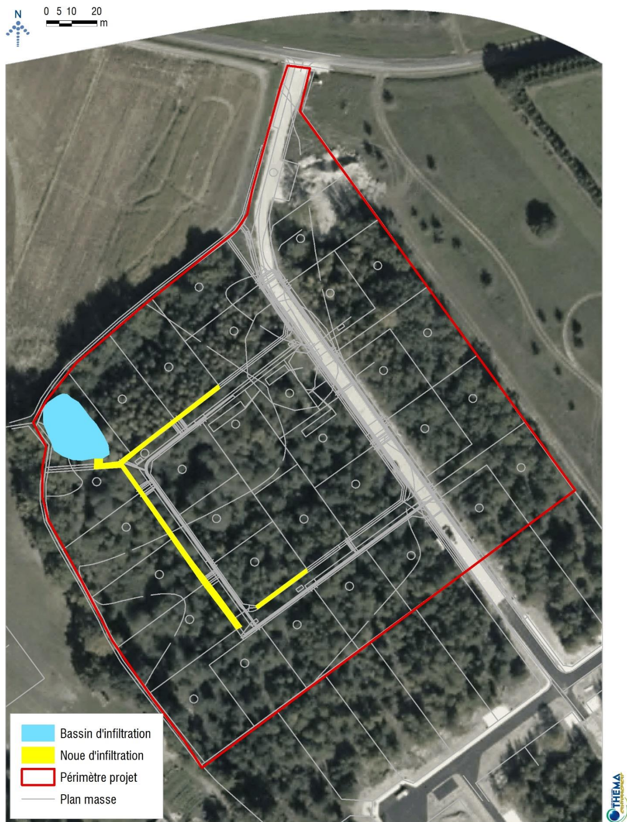
Figure 22 : Localisation de principe des ouvrages d'infiltration
