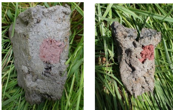
Figure 14 : Exemple du précipité rouge de la réaction du test à la phénanthroline
