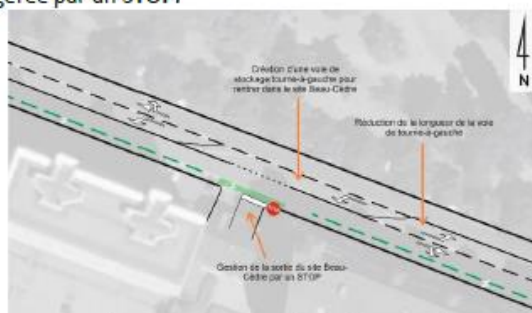
Proposition d'aménagement permettant d'inclure la nouvelle entrée/sortie dans la circulation du Boulevard Guy Marie-Riobé
