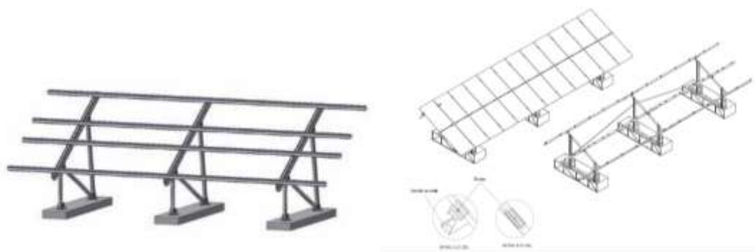
Exemple de châssis fixés sur des longrines en béton
