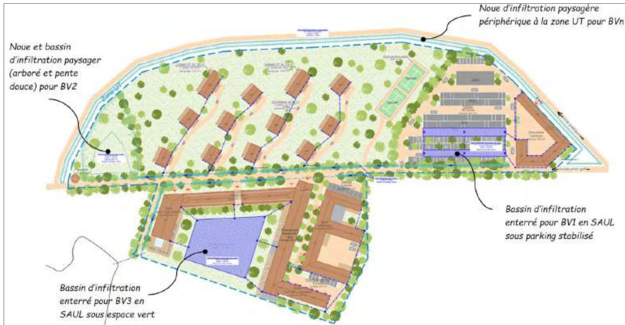
Figure 45 : Gestion des eaux pluviales sur le projet (Source : LOGABAT ingénierie - Notice Hydraulique – 23 juillet 2024)
