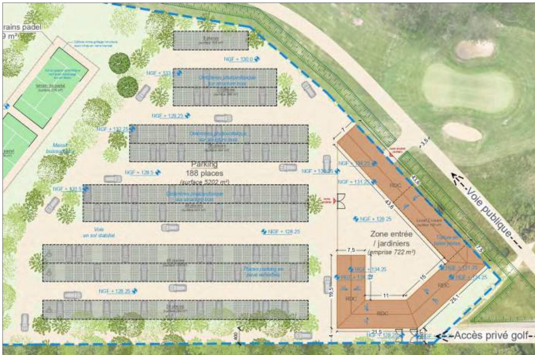
Figure 39 : Zone de parking avec en rouge l'emplacement des ombrière photovoltaïques (Source : SALIN architecte 24/07/2024)
