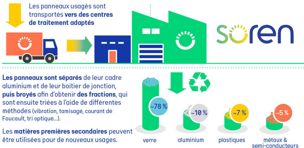
Figure 35 - Le traitement des panneaux photovoltaïques par SOREN. Source : SOREN.
