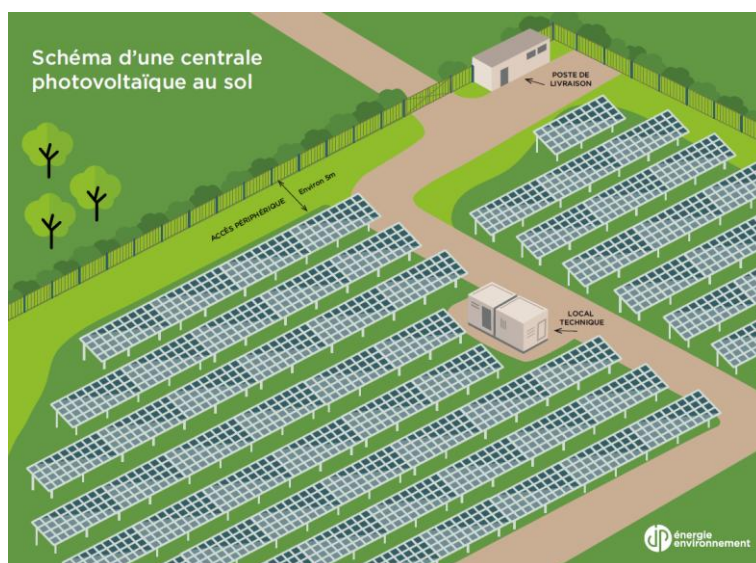
Schéma d'une centrale photovoltaïque au sol
